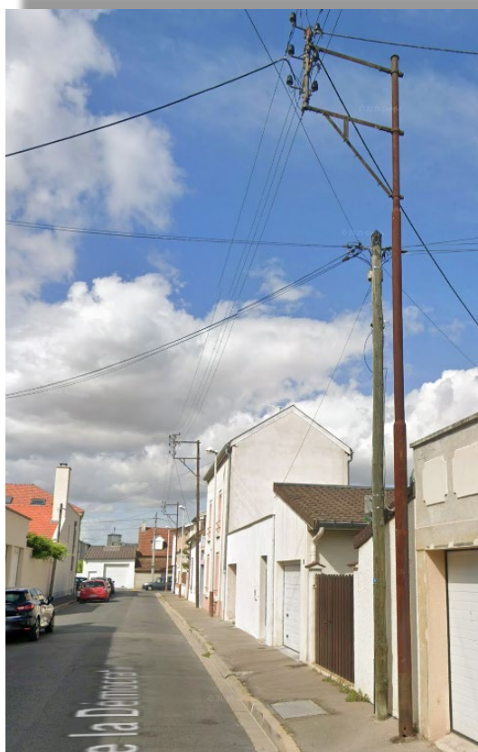
Réseau aérien fils nus avec supports tubulaire à Reims (source Google maps)
